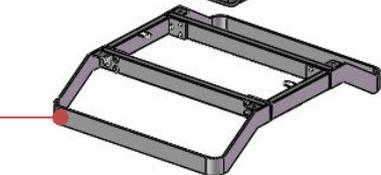
茶几脚，由五金钢架构成，可拆装结构，便于包装和运输
